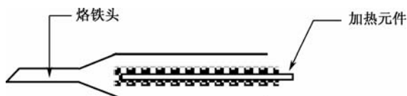
图 5.8 内热式电烙铁结构图
