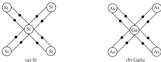
图 4-2 x 空间结构的二维简化图,黑点表示形成共价键的电子
