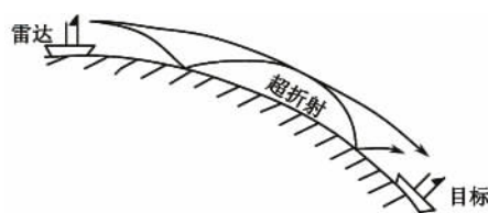
图 9.26 大气波导超视距雷达
