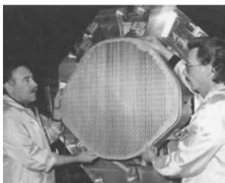
(a) AN/APG—77 有源相控阵天线
