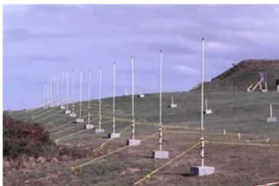
图 9.25 德国汉堡大学研制的 WERA 地波雷达系统
