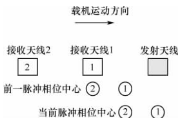
图 5.32 相位中心及 DPCA 工作原理图
