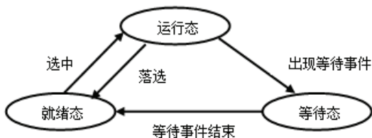
图 2-3 进程三态模型及其状态转换
