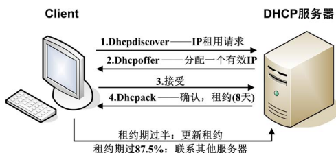
图 4-6 DHCP 服务流程
