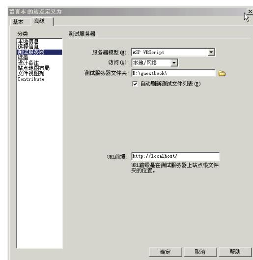
图 14-45 设置测试服务器
