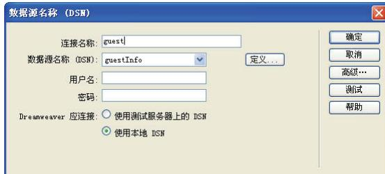
图 14-50 创建 DSN 数据源连接
