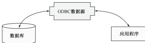
图 14-18 通过 ODBC 数据源连接示意图
