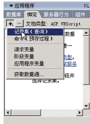
图 15-10 在“绑定”面板中选择“记录集(查询)”命令
