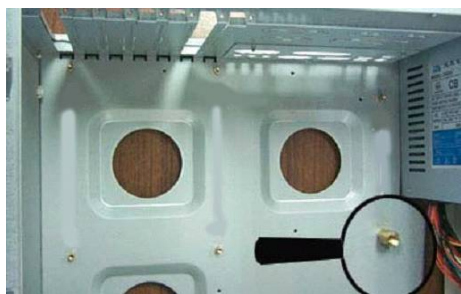
图 6-19 安装机箱托板上铜制螺钉
