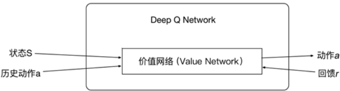
图 12-6 DQN 算法的基本结构
