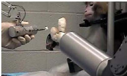
图2 利用植入电极控制假肢的运动
