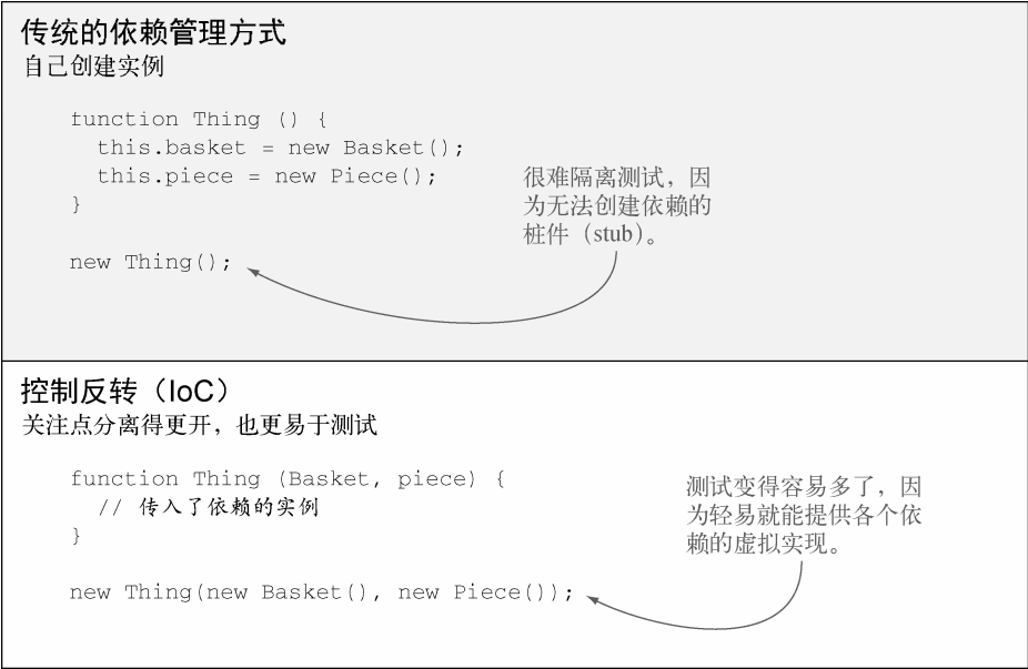
图5-3 IoC比传统的依赖管理方式提升了可测试性
