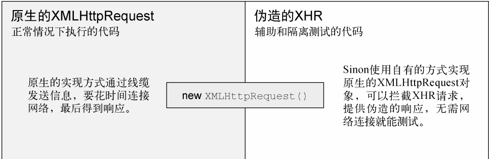
图8-3 比较原生的XMLHttpRequest和测试中伪造的XHR驱动
