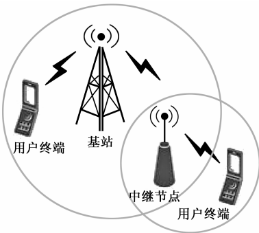
图 7-1 Relay 原理示意图
