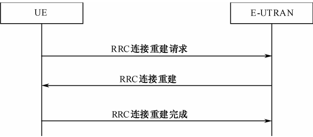
图 5-46 RRC 连接重建成功过程
