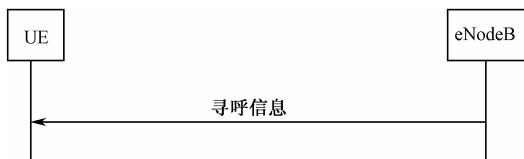
图 5-54 eNodeB 发起寻呼流程
