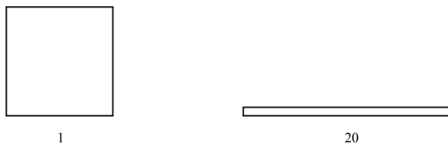
图 5.4.10 四边形网格 Aspect Ratio
