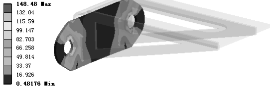
图 7.11.23 应力结果图解 (FIX-BOARD)
