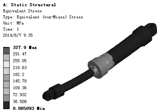
图 7.6.28 应力结果图解
