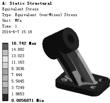
图 7.2.7 应力结果图解
