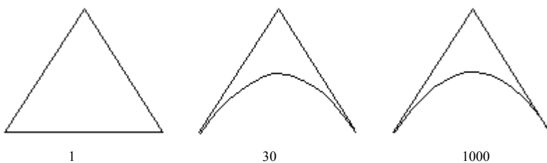
图 5.4.12 三角形网格 Jacobian Ratio
