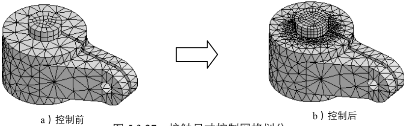
图 5.3.27 接触尺寸控制网格划分
