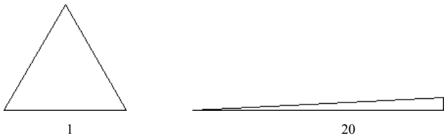
图 5.4.9 三角形网格 Aspect Ratio
