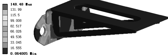
图 7.11.20 应力结果图解
