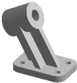
图 7.2.1 固定支架模型
