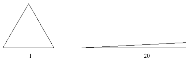
图 5.4.9 三角形网格 Aspect Ratio
