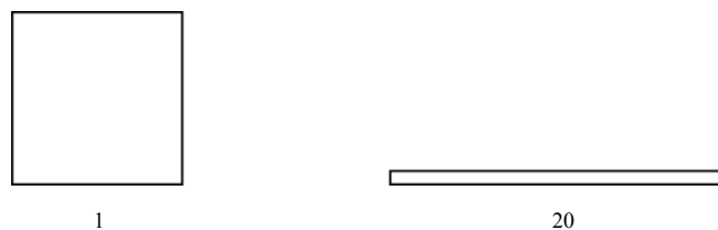
图 5.4.10 四边形网格 Aspect Ratio
