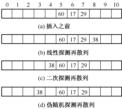
图 10.4.2 用开放定址处理冲突时, 关键字为 38 的记录插入前后的 Hash 表
