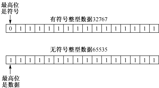
图 1.2.2 有无符号短整型数据的存储情况
