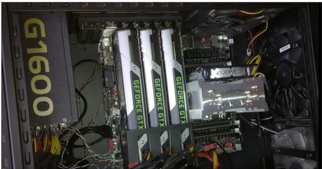
图 1.5 三块 GTX Titan 卡和一块 InfiniBand 卡（这是为深度学习配置的）
