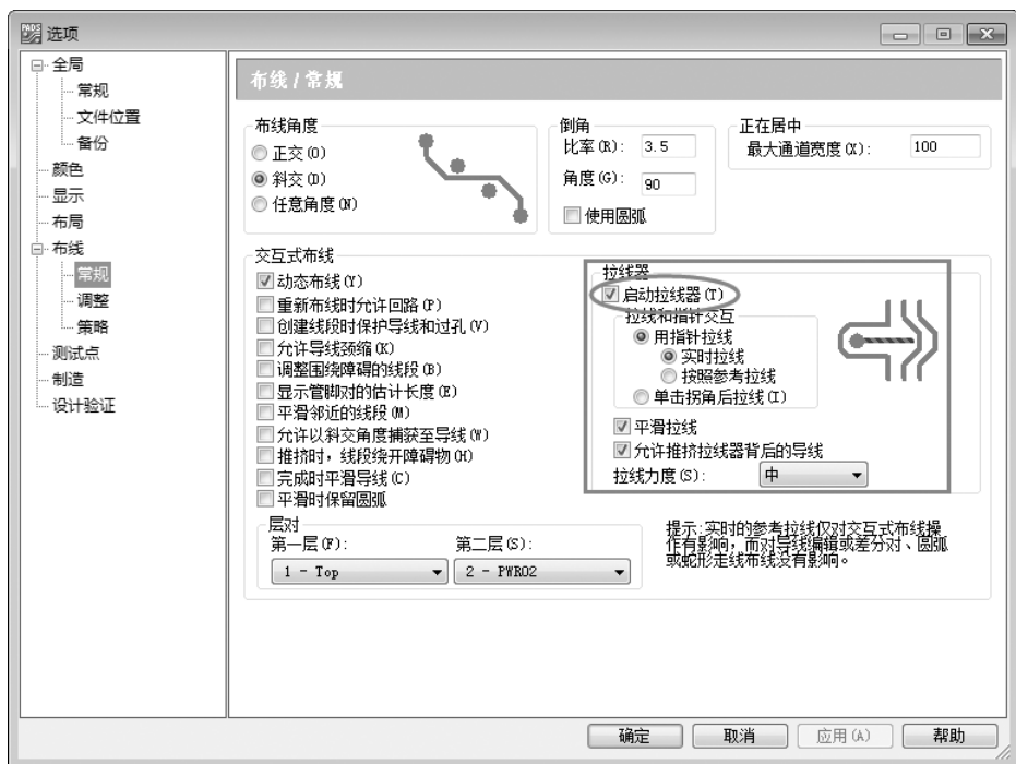
图 6-115 拉线器推荐设置
