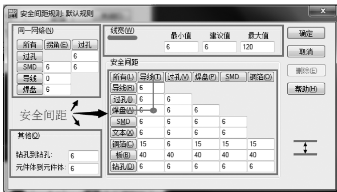
图 3-55 安全间距和线宽设置
