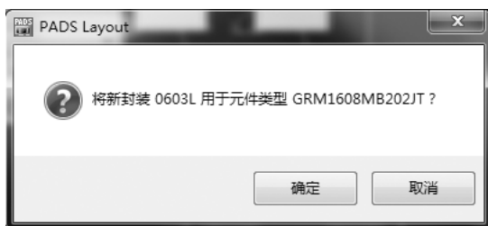
图4-34 新封装用于元件类型
