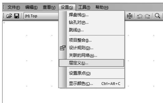
图 2-31 执行菜单命令【设置】-【层定义】
