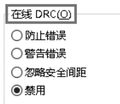
图 3-12 在线 DRC 设置
