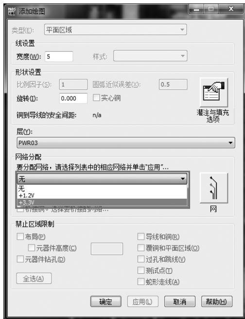
图 3-38 分配分割/混合平面网络
