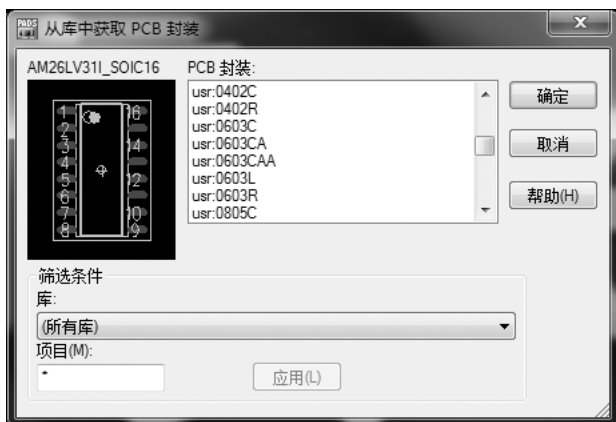
图 4-32 从库中获取 PCB 封装
