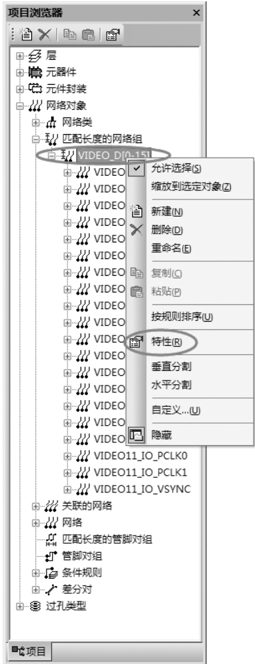
图 6-131 进入匹配长度的网络组特性
