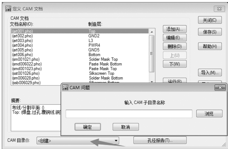
图 8-68 输出 CAM 文档
