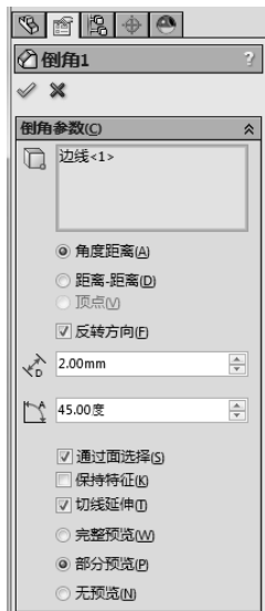
图 5-13 设置倒角属性
