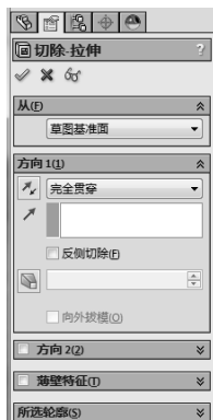
图 9-70 设置切除-拉伸属性
