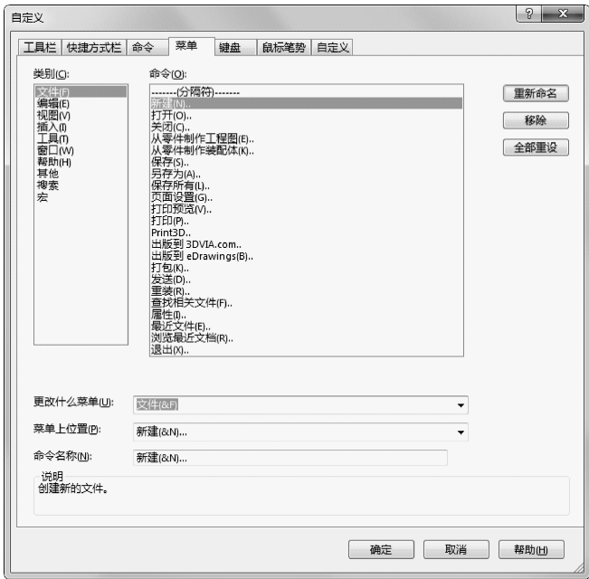
图 1-13 自定义菜单操控板
