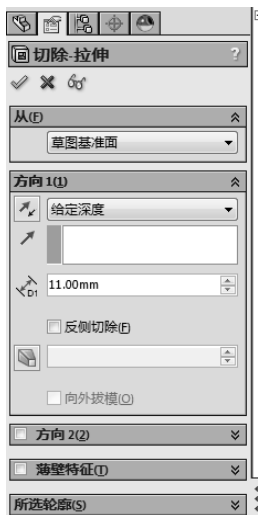
图 9-17 设置切除-拉伸属性
