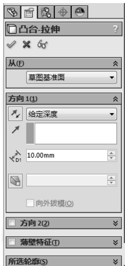
图 5-134 设置凸台-拉伸属性
