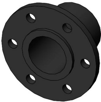
图 5-132 法兰盘零件模型
