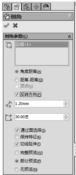
图 4-72 设置倒角属性
