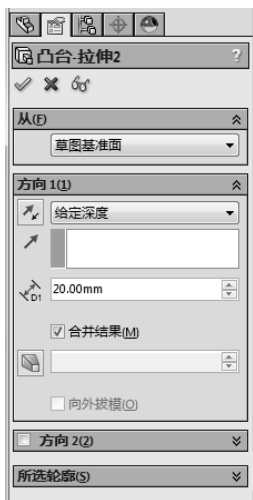
图 1-16 拉伸建模时 PropertyManager 属性管理器
