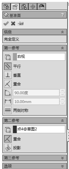
图 5-55 设置基准面属性
