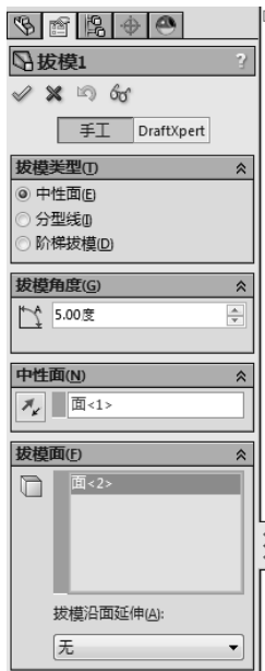
图 4-81 设置拔模属性
