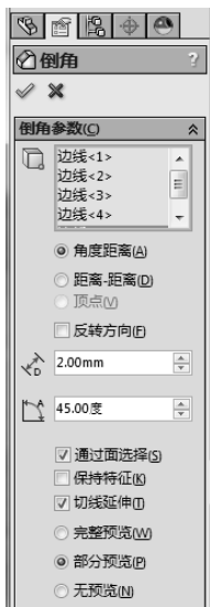
图 9-73 设置倒角属性
