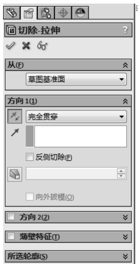
图 9-10 设置切除-拉伸属性
