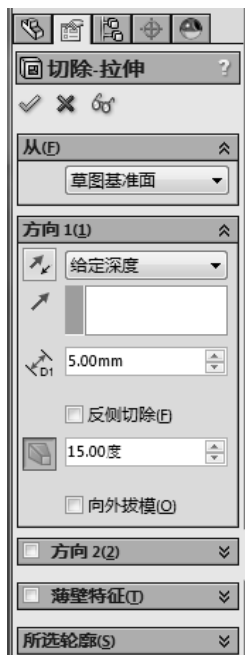
图 9-86 设置切除-拉伸属性
