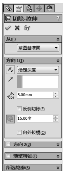
图 9-92 切除-拉伸 属性设置
