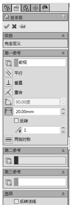
图 2-4 设置基准面属性
