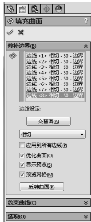
图 6-102 设置填充曲面属性
