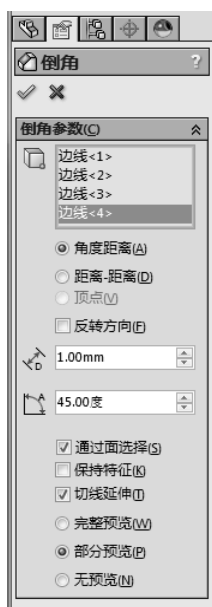
图 9-95 设置倒角属性
