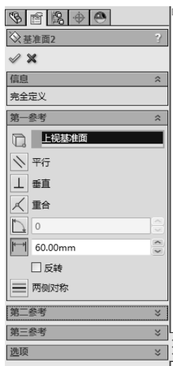
图 9-13 设置基准面属性
