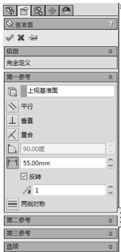
图 4-114 设置基准面属性
