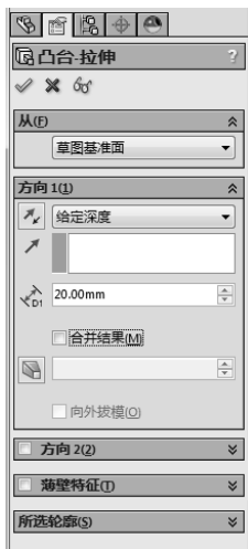
图 5-112 设置凸台-拉伸属性
