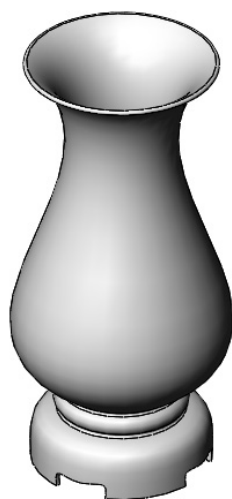
图 6-154 生成圆角曲面
