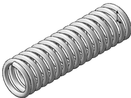
图 9-40 切除-拉伸弹簧端面
