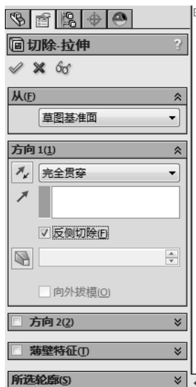
图 4-34 设置切除-拉伸属性
