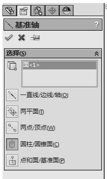
图 2-9 设置基准轴属性
