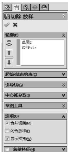
图 4-54 设置切除-放样属性
