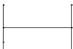
图 3-27 直线延伸到右侧直线上
