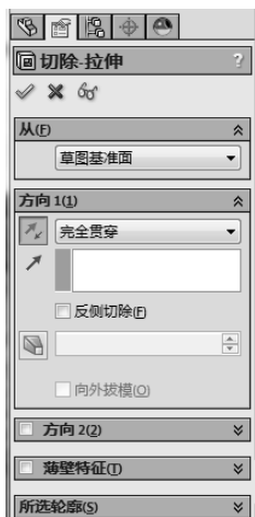
图 9-45 设置切除-拉伸属性
