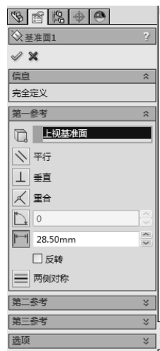
图 9-6 设置基准面属性
