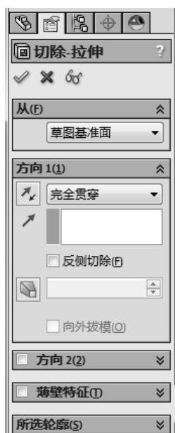
图 9-82 设置切除-拉伸属性
