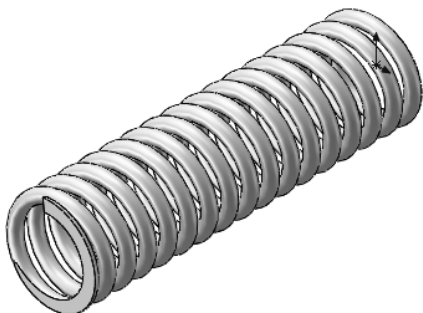
图 9-47 切除-拉伸弹簧端面
