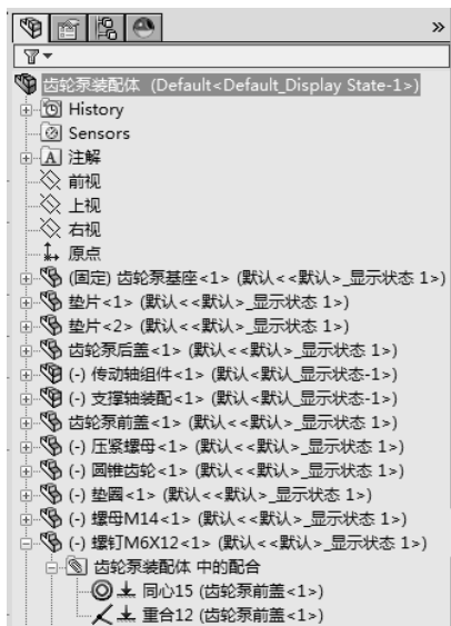
图 10-48 添加螺钉配合关系
