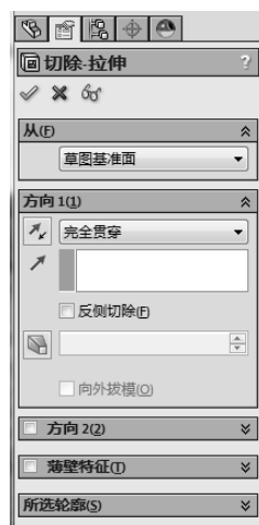
图 9-38 设置切除-拉伸属性
