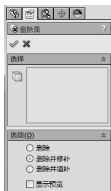
图 6-115 删除面操控板
