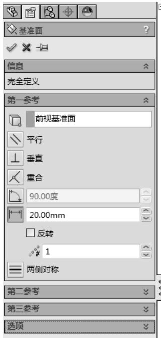
图 4-108 设置基准面属性
