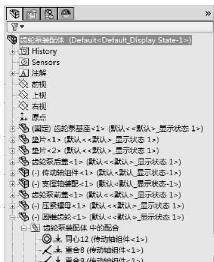
图 10-36 添加圆锥齿轮配合关系
