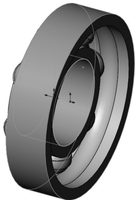
图 7-122 预览添加同轴心配合后的装配体
