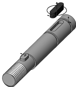
图 7-87 拖动平移或旋转控标以移动 选定“平键 1”零件
