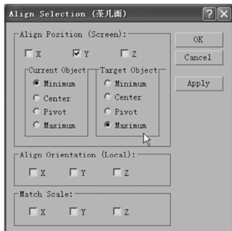
图 2-4 在 Front 视图的 Y 轴方向上将 “贴面”底部和“茶几面”顶部对齐
