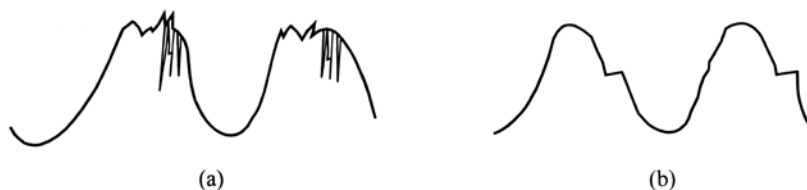
图 1-14 大信号自激时的两种自激波形
