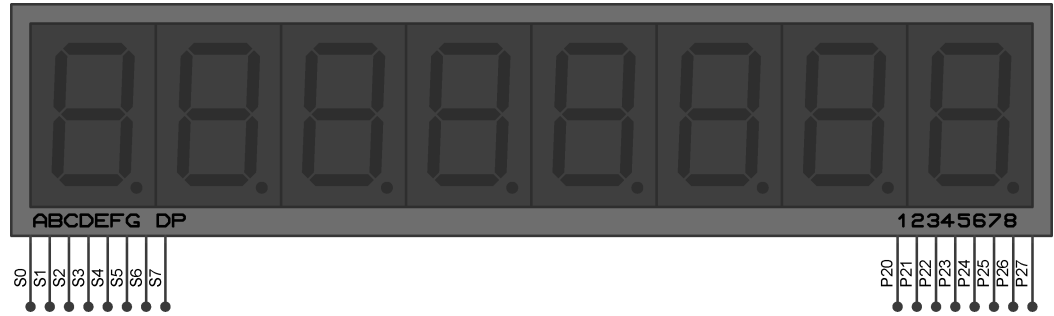
图 16-4 共阴数码管原理图
