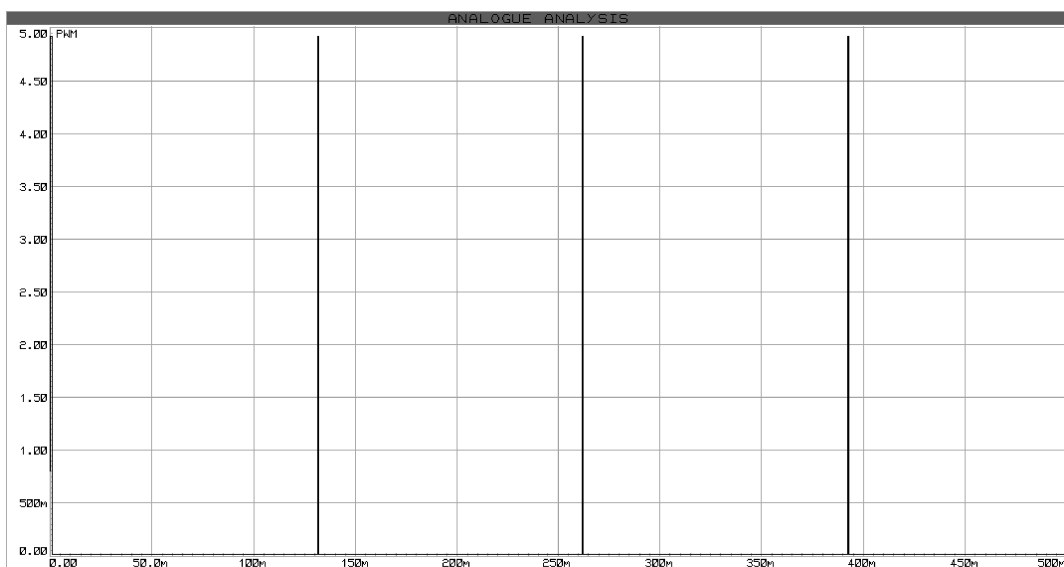
图 2-10 输入为 5V 时的 PWM 波形（反转）
