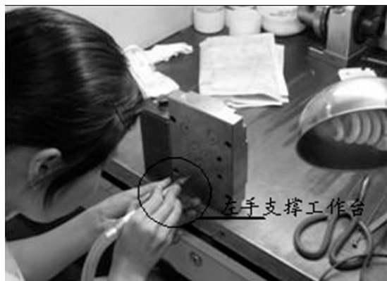
图 8-27 左手后背支撑工作台
