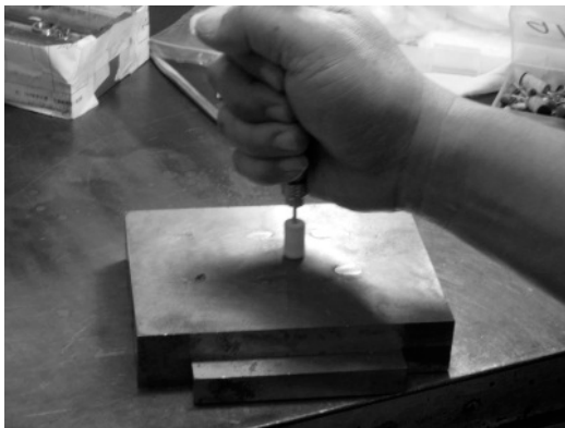
图 8-6 抛光轮安装在抛光机上
