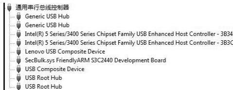
图 4.34 “设备管理器”中 USB 下载驱动安装成功
