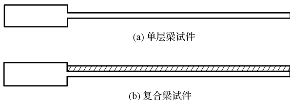
图 8-19 悬臂梁法典型试件示意图
