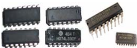
图 2.1 集成逻辑门芯片
