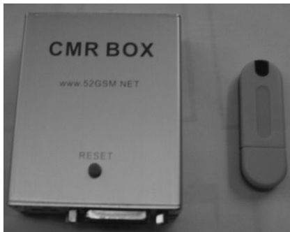
图 4-1-2 全功能免拆机带计算机软件维修仪外形结构
