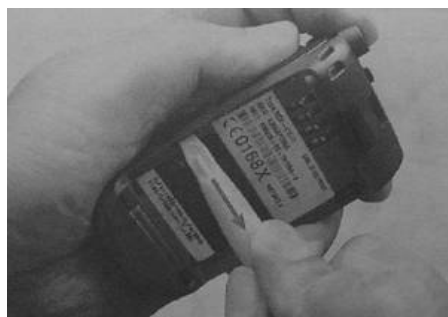
用工具 D 或 E 拨开后壳下方的两个锁扣
