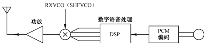
图 2-3-18 直接变频发射电路
