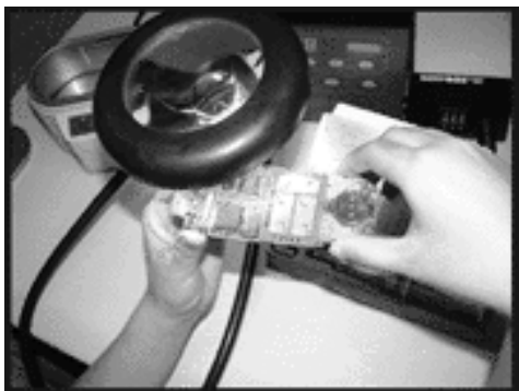
图 3-2-5 BGA 焊接后的检查测试
