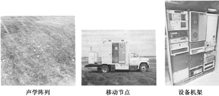
图 1-1 1985 年前后 DSN 测试床的组成
