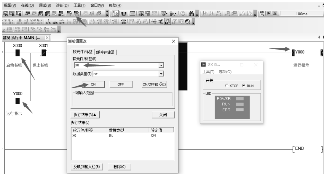
图 5-3-18 启动按键按下的 PLC 程序调试
