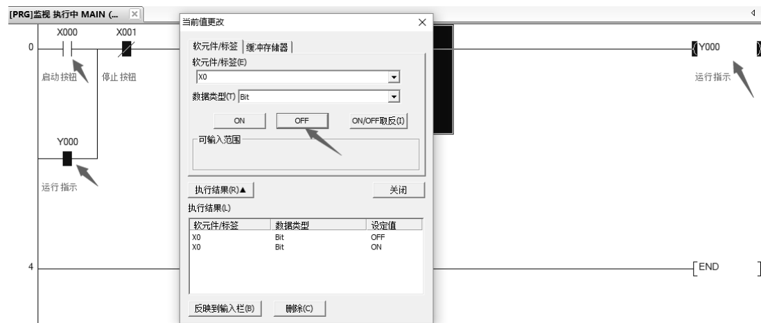
图 5-3-19 启动按钮松开的 PLC 程序调试
