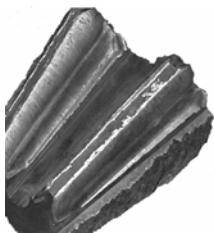
图 7-30 齿面磨粒磨损
