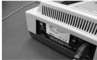
图 7.35 无接地保护
