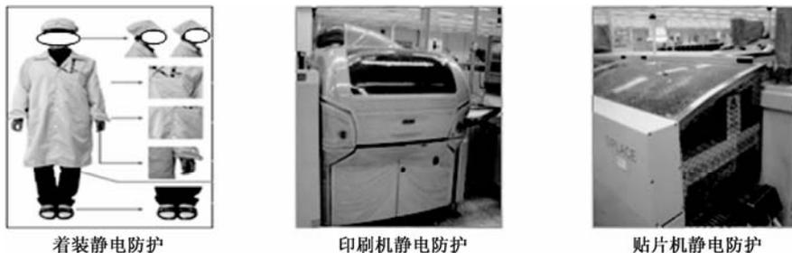
图 3.27 生产物流现场静电防护图例 (1)
