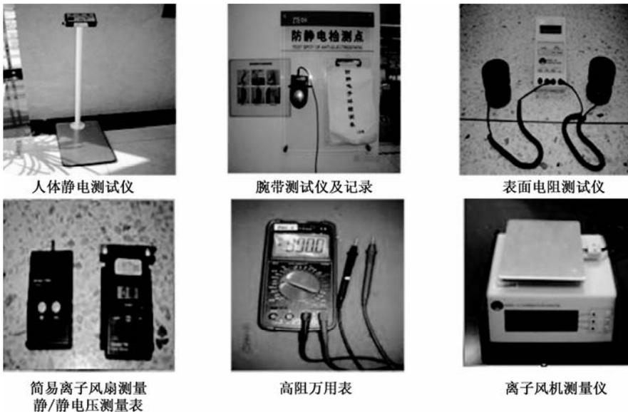
图 3.7 静电测量仪器
