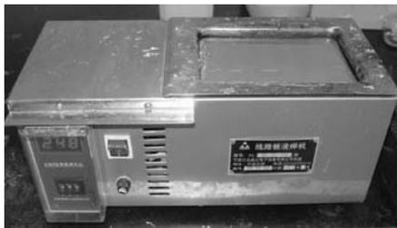
图 9.1 焊料槽浸焊可焊性测试仪
