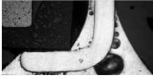
图 5.9 钽电容引脚氧化导致焊接空洞
