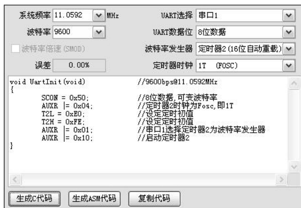
Figure 8.11 Parameter Configuration and Baud-rate Generation Subroutine of Baud-rate Calculator (C Program) 波特率计算器参数设置与生成的波特率子程序 (C 语言格式)
