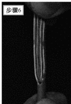
图 1-16 将 8 根导线整齐地平行排列
