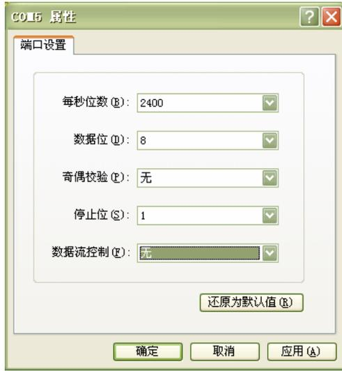
图 1-44 设备之间的连接参数
