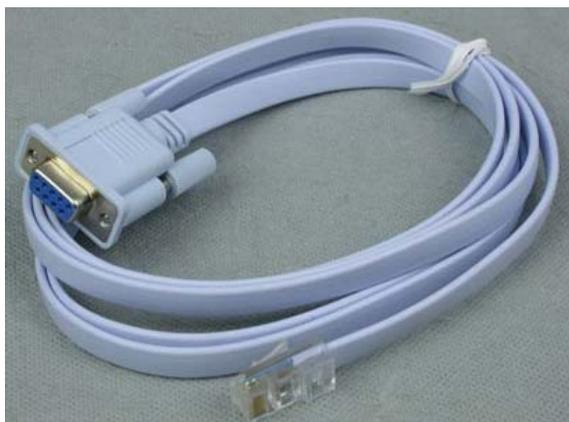
图 1-38 随交换机附带的 Console 连线
