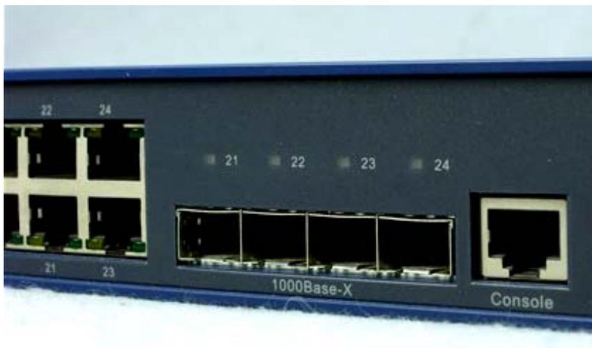
图 1-37 可网管交换机的网管配置 Console 端口
