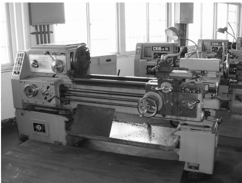
1—进给箱；2—挂轮箱；3—主轴变速箱；4—溜板与刀架；5—溜板箱；6—尾座； 7—丝杠；8—光杠；9—床身
