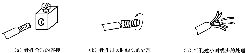
图 2-95 多股芯线与针孔接线桩连接
