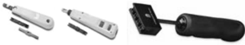
图 1.10 常用的打线工具
