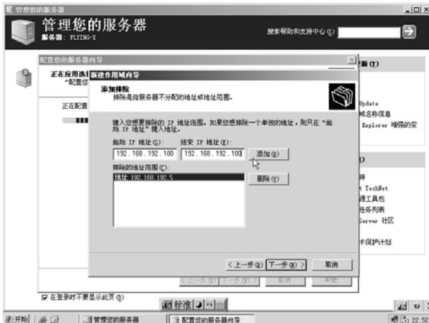
图 6.13 设置排除的 IP 地址信息
