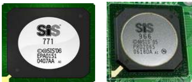
图 3-50 北桥 SiS771+南桥 SiS966 芯片组
