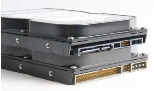
图 4-9 SATA 硬盘（上）和 IDE 硬盘（下）的接口对比
