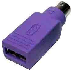
图 5-4 键盘的 USB 接口转 PS/2 接口的转接口
