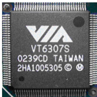
图 3-27 VIA VT6307S 控制芯片
