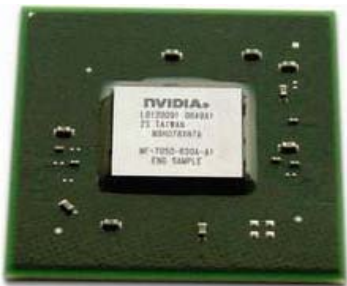
图 3-42 nVIDIA 的 Geforce 780a 芯片
