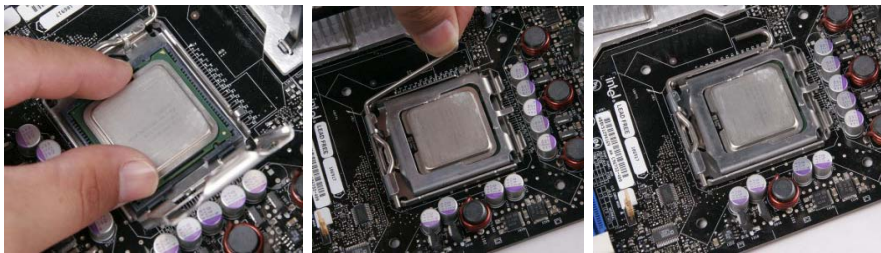
图 8-10 安装 LGA 775 型 CPU
