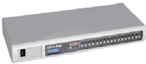
图 7-9 RJ-45 端口 Hub
