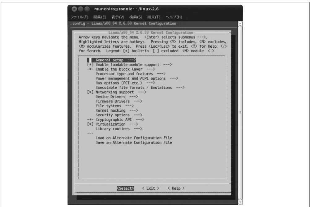
图 1-2 make menuconfig 生成的设置画面
