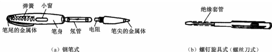
图 1.1 低压测电笔
