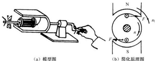
图 2.3 异步电动机转动原理模型
