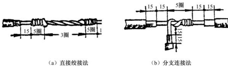
图 1.11 单股铜导线的绞接法
