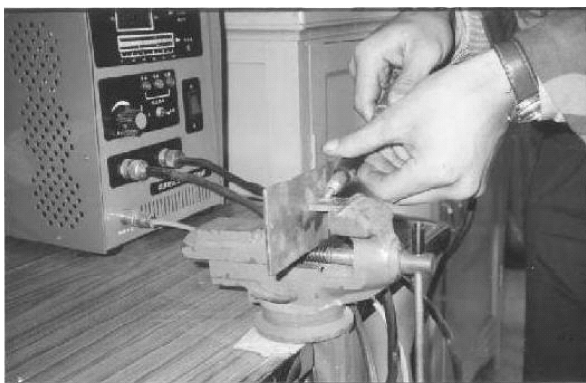
图 5-13 微脉冲电阻焊焊补操作示意图
