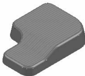
图 2-282 前倾角 30° 生成的刀具路径
