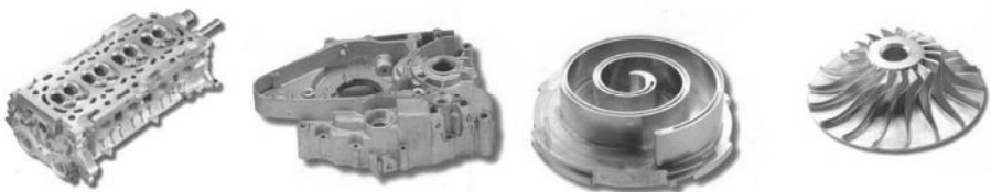
图 4-2 加工中心加工的典型零件
