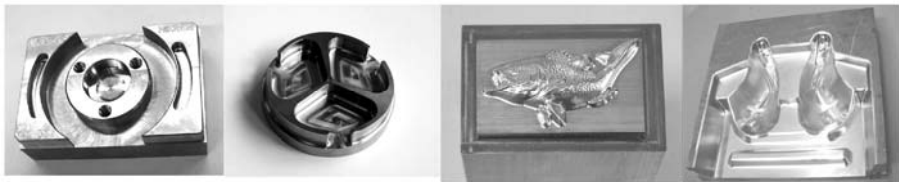
图 4-1 数控铣床加工的典型零件
