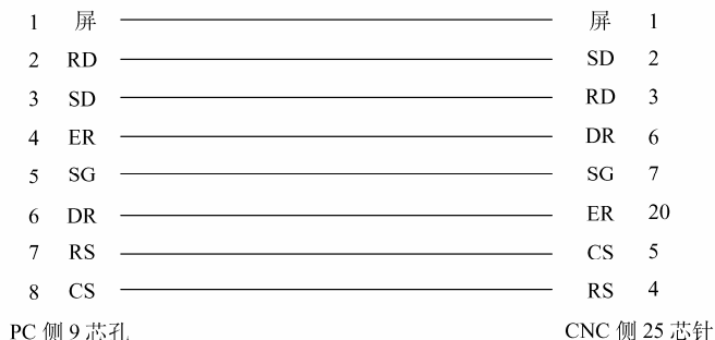
图 1-30 通信电缆接线图
