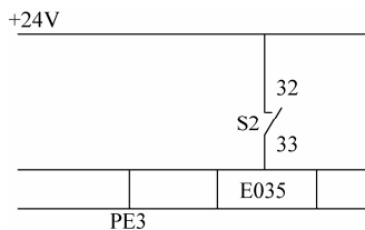
图 4-24 热保护器控制图
