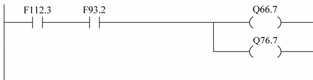
图 2-24 总进给使能 Q66.7 和 Q76.7 的梯形图
