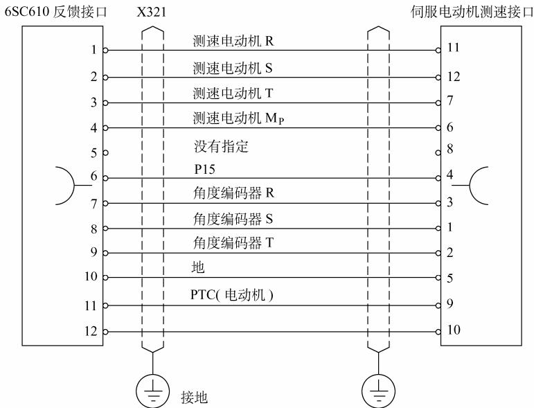
图 1-34 西门子 6SC610 伺服系统控制模块速度反馈接口连接图
