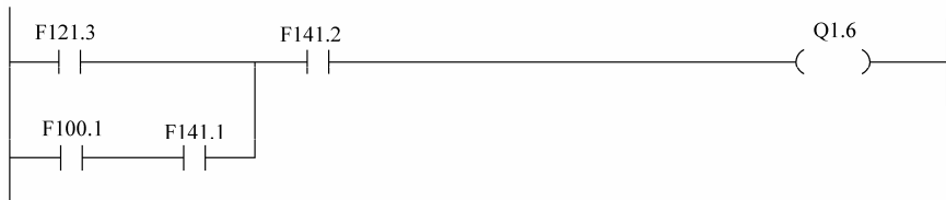
图 2-34 关于 PLC 输出 Q1.6 的梯形图
