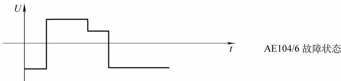
图 4-28 故障时启动脉冲波形图
