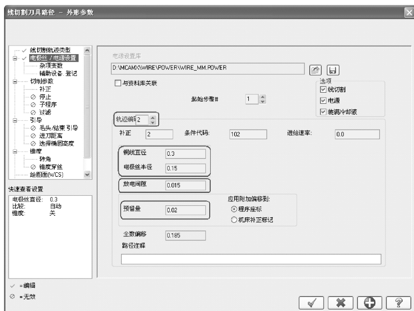
图 9-29 第二次切割电极丝和电源设置
