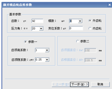
图 3-30 渐开线齿轮齿形参数
