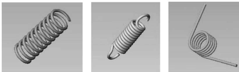
图 7-64 三种典型的螺旋弹簧
