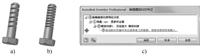
图 4-139 同一个扫掠截面在不同的螺距下的扫掠结果
