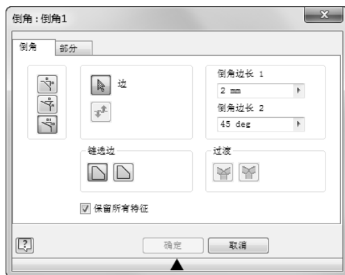
图 5-30 用两个边长创建倒角
