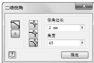
图 3-37 “距离-角度”倒角方式
