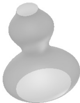
图 7-15 创建旋转曲面
