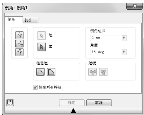
图 5-29 用倒角边长和角度创建倒角
