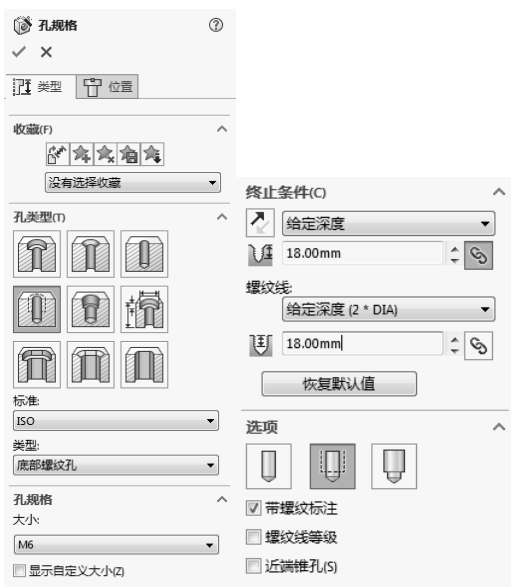
图 7-117 正面 M6 螺纹孔 1 参数设置
