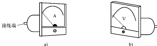
图 5-9 电流表和电压表的外形
