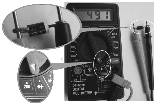
图 3-21 测二极管的正向电阻
