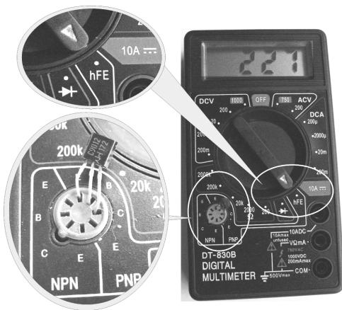
图 3-23 测量 PNP 型晶体管 C9012 的放大倍数
