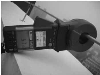
图 3-36 测避雷带的接地电阻
