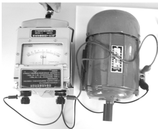
图 3-32 用绝缘电阻表测量电动机绕组相间的绝缘电阻
