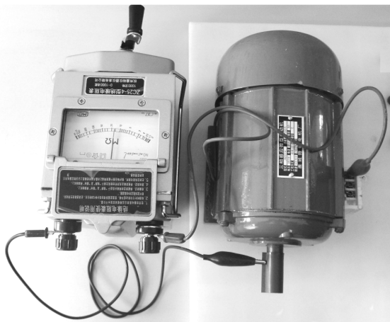
图 3-31 用绝缘电阻表测量电动机绕组对外壳的绝缘电阻
