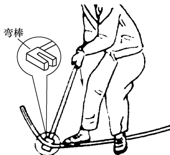
图 2-48 细钢管用弯管器弯制钢管
