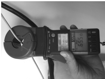
图 3-35 测接地线的接地电阻
