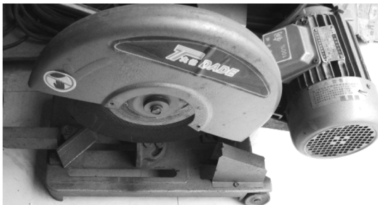
图 2-47 用砂轮机切割钢管
