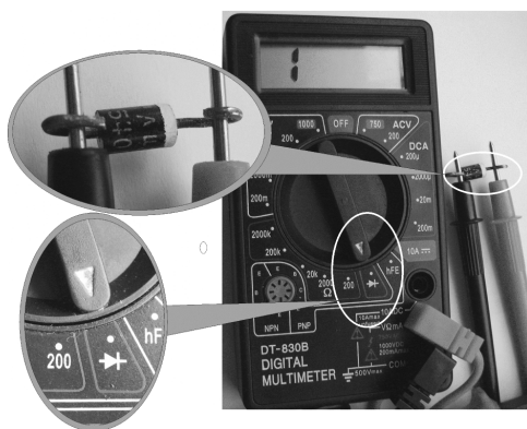
图 3-22 测二极管的反向电阻
