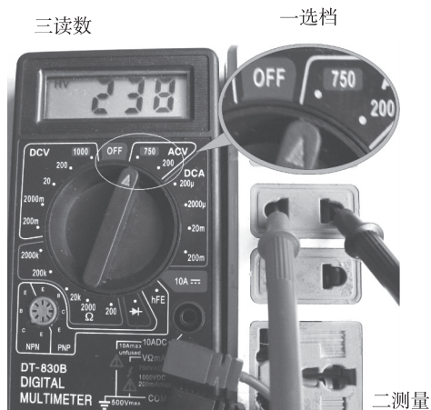
图 3-18 测市电插座上的电压
