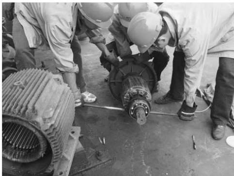
图 2-15 将组装好的后端盖和转子装入定子绕组内
