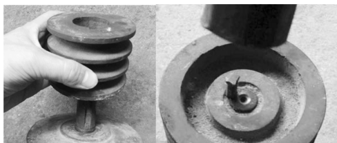
对准键槽套入带轮
