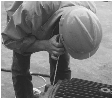
图 2-20 通过长柄螺钉旋具 （螺丝刀）听轴承运行中的声音
