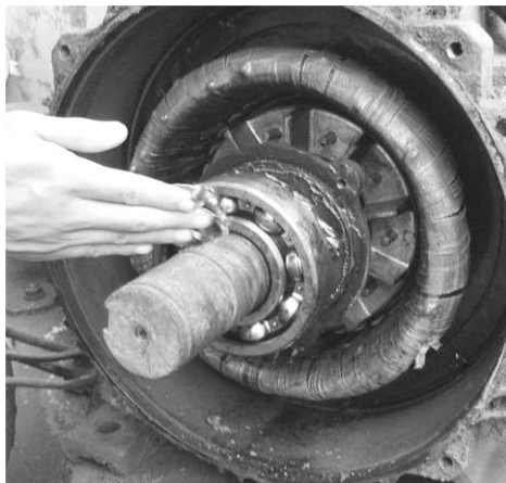
图 2-16 向另一侧轴承及轴承盖上加油
