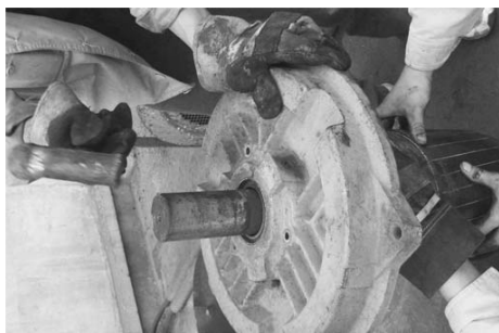
图 2-14 将后端盖安装到转子上
