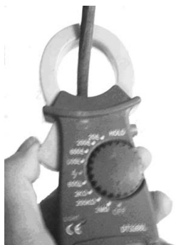
图 5-10 测量空载电流
