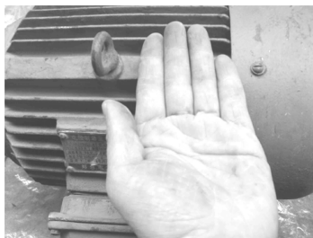
图 2-29 用手背检查电动机 外壳是否过热
