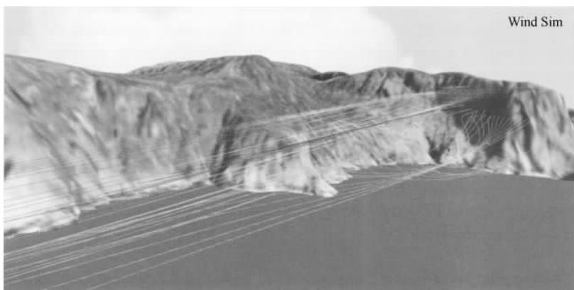
图 13-5 Wind Sim 等 CFD 模型能模拟非线性流场特征，例如陡峭地形背后的反复循环。（来源：WindSim AS）
