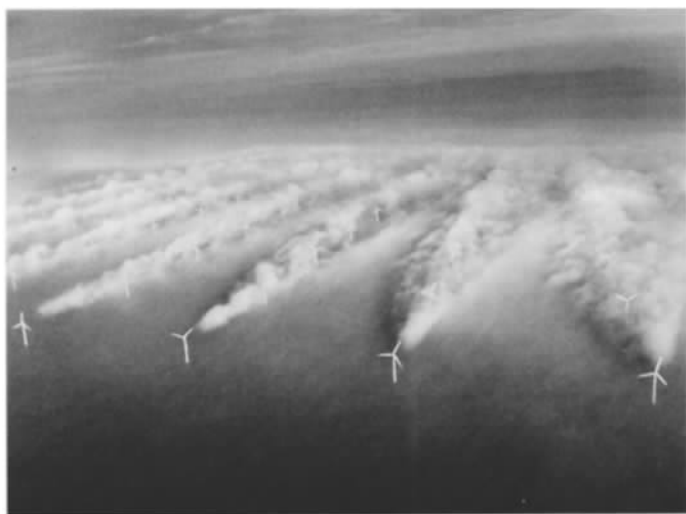
图 1-5 难得一见的海上风电场风力机尾流证据。每台风力机后面不断增大的湍流导致空气中水汽凝结成小水滴，形成可见的凝结尾。每个尾流的风速也降低了。
