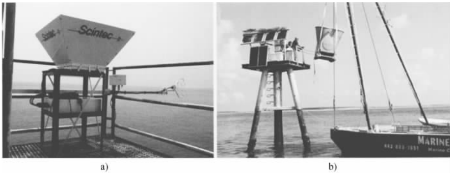
图 14-9 a) 安装在美国纽约州沿海 Ambrose Light C-MAN 站点的 Scintec 雷达。(来源: AWS Truepower); b) 美国南卡罗莱纳海上一台 Second Wind 声雷达正在往美国海岸警卫队 (U. S. Coast Guard) 平台上吊装。(来源: Second Wind)
