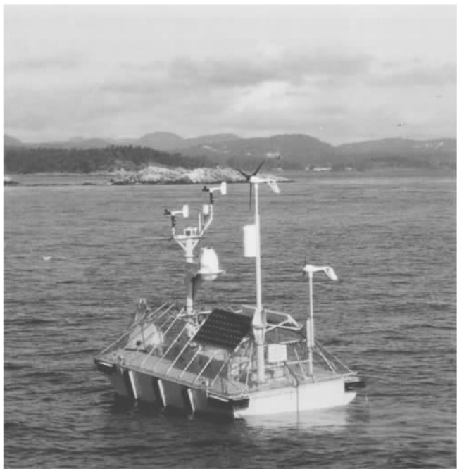
图 14-8 含有 Catch the Wind 的 Vindicator 雷达的 WindSentinel 水上雷达系统，安装在 AXYS Technologies 开发的 NOMAD 浮标上。（来源：AXYS Technologies）
