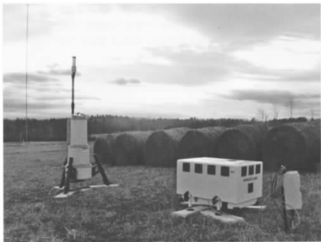
图 8-3 NRG/Leosphere 的 Windcube Lidar (右) ① 和 Natural Power 公司的 ZephIR Lidar 设备。 (来源：AWS Truepower)
