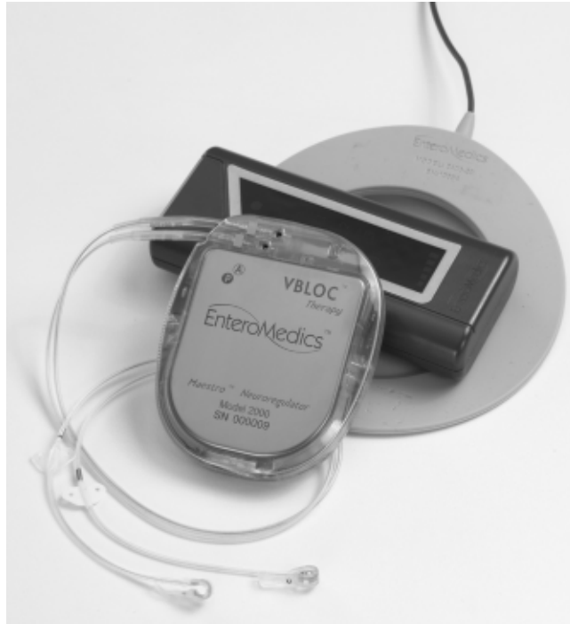
图 13.1 EnteroMedics Maestro®系统迷走神经阻断设备 ( 版权© EnteroMedics。经许可转载 )
