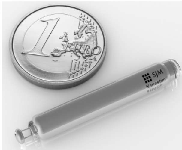
图 6.17 Nanostim™无引线起搏器（版权©St Jude Medical。经许可转载）
